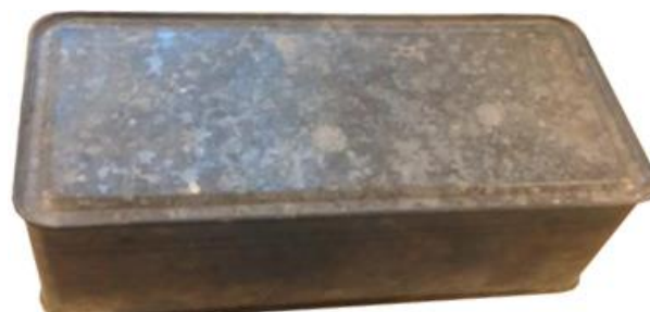
Caissette sertie à ouverture latérale haute coté opposé aux marquages (marquages frappés sur la face opposée à la face couvercle bombée)
