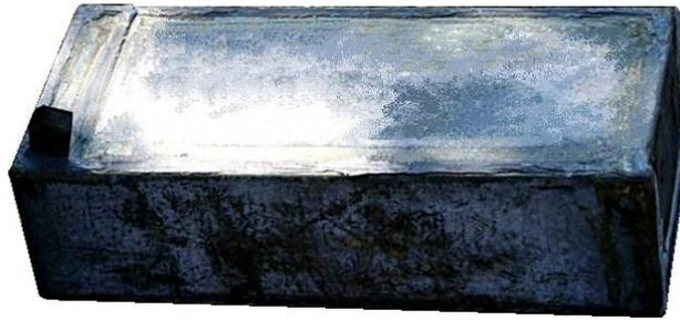
Ce sont des caissettes en acier galvanisé plié et soudé à l'étain identiques aux caissettes mle 38. Ces caissettes de dimensions 352,8 x 152,4 x 97,4 mm et d'un poids de 0,7 kg, ont plusieurs particularités :
