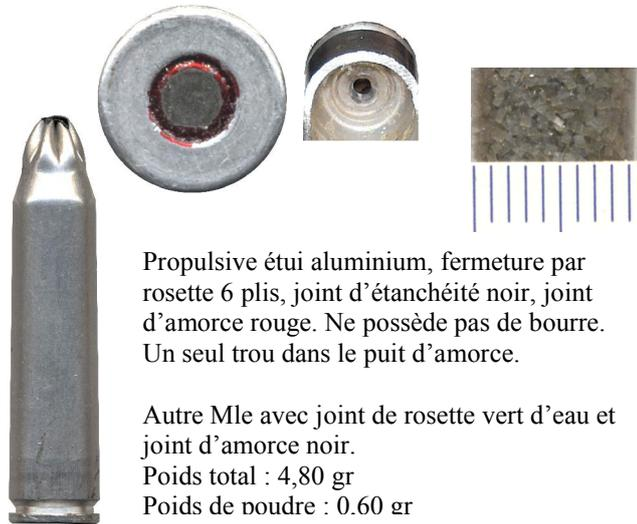
Propulsive étui aluminium, fermeture par rosette 6 plis, joint d'étanchéité noir, joint d'amorce rouge. Ne possède pas de bourre. Un seul trou dans le puit d'amorce.
