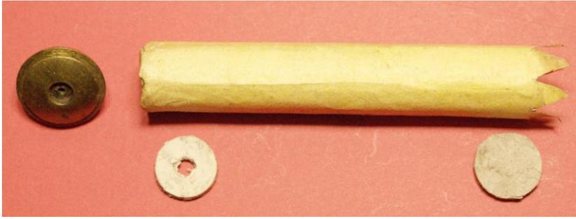
Divers éléments d'une cartouche de chasse : rosette, carton percé placé au fond de l'étui pour vissage de la rosette, étui en papier roulé, carton de fermeture sous les languettes.
