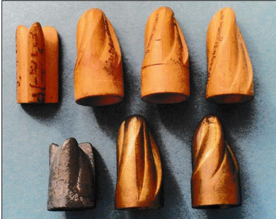
Projectiles rotatifs de l'École d'application de l'Artillerie et du Génie de Metz de 1859-60.
