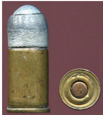
.450 Adams MkI à balle Pertuiset (noter le marquage vertical sur la balle) 9mm revolver français à balle Pertuiset
