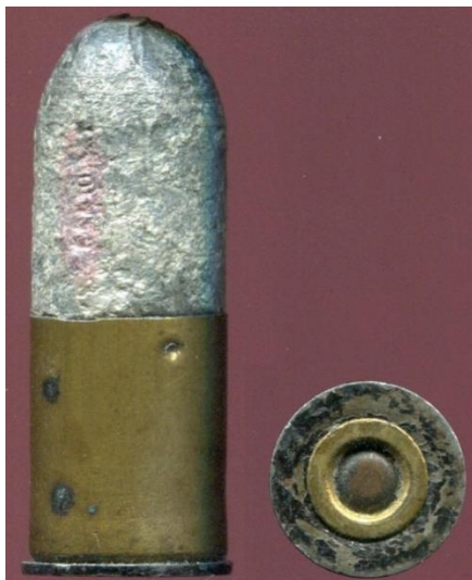
.450 Adams MkI à balle Pertuiset (noter le marquage vertical sur la balle) 9mm revolver français à balle Pertuiset
