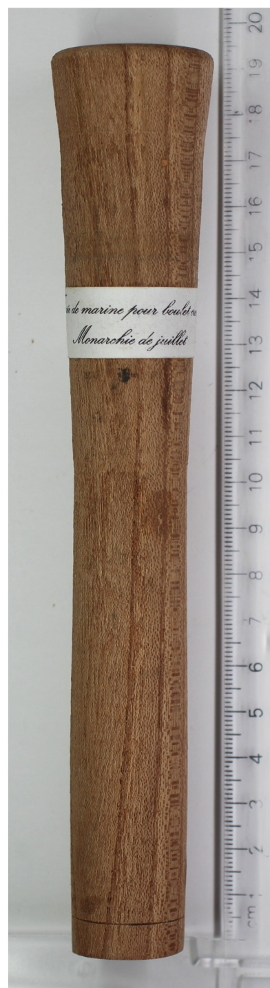
Fusée de marine pour boulet creux de 22 cm fabriquée durant la Monarchie de Juillet. Réalisée en orme
