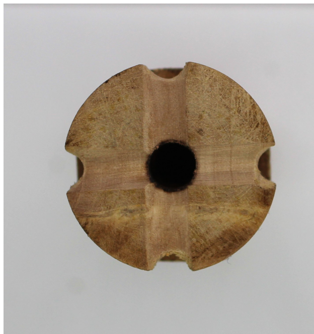
Fusée mle 1853 numéro 4 pour obus de 12 centimètres; vue longitudinale et de haut.
