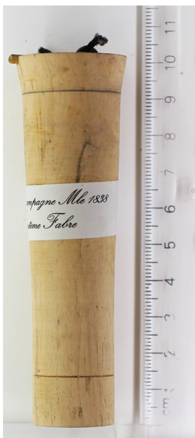
Fusée de campagne 1838 du capitaine Fabre en bois d'aulne chargée de composition, munie de ses deux broches métalliques, on voit les brins d'étoupille grossièrement perpendiculaires aux broches
