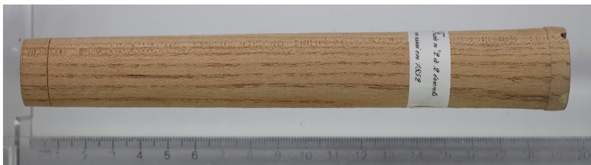
Fusée n° 2 à deux événements en essai en 1852
