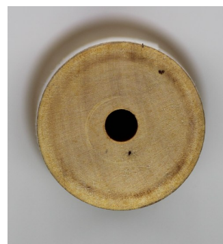
Fusée du système Guérin 1846 en bois de tilleul, à droite côté culot, à gauche vue sur une lumière d'étoupe.
