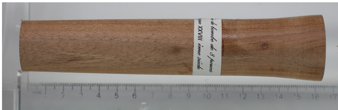
Fusée pour bombe de 8 pouce du modèle employée au XVIIIème siècle, réalisé en orme
