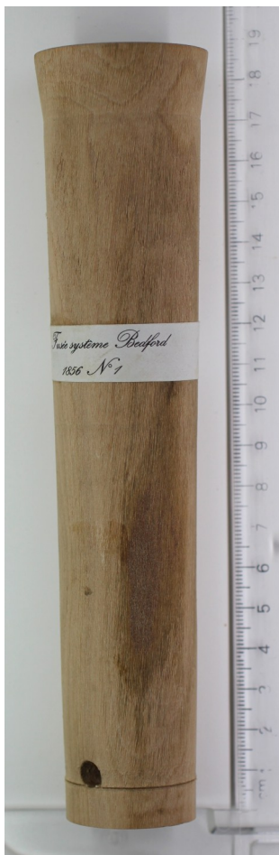
A gauche : Fusée Bedford 1856 N° 1 en bois d'aulne , vue longitudinale et de haut.
