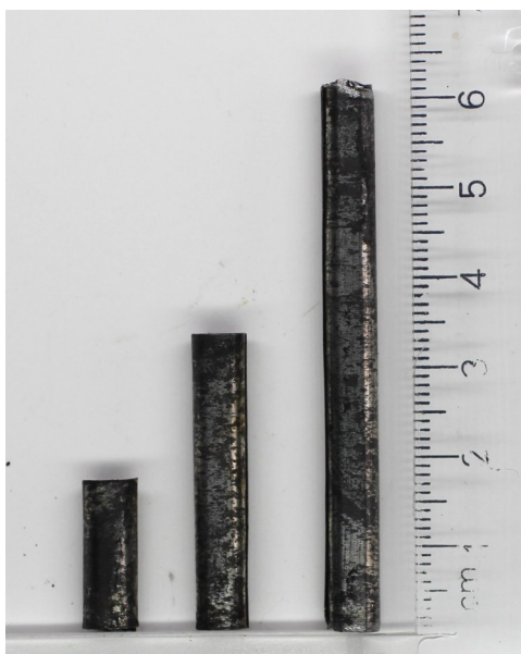
Tubes métallique de fer blanc contenant la composition fusante destinés à déterminer le temps de combustion de la fusée.
