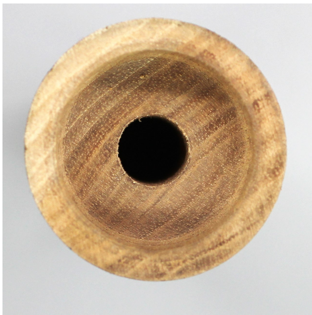
Fusée de campagne N° 1 en bois d'orme dont les côtes correspondent à celles données par l'aide mémoire des officiers d'artillerie de 1844
