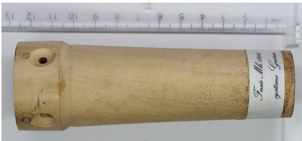
Fusée du système Guérin 1846 en bois de tilleul, à droite côté culot, à gauche vue sur une lumière d'étoupe.
