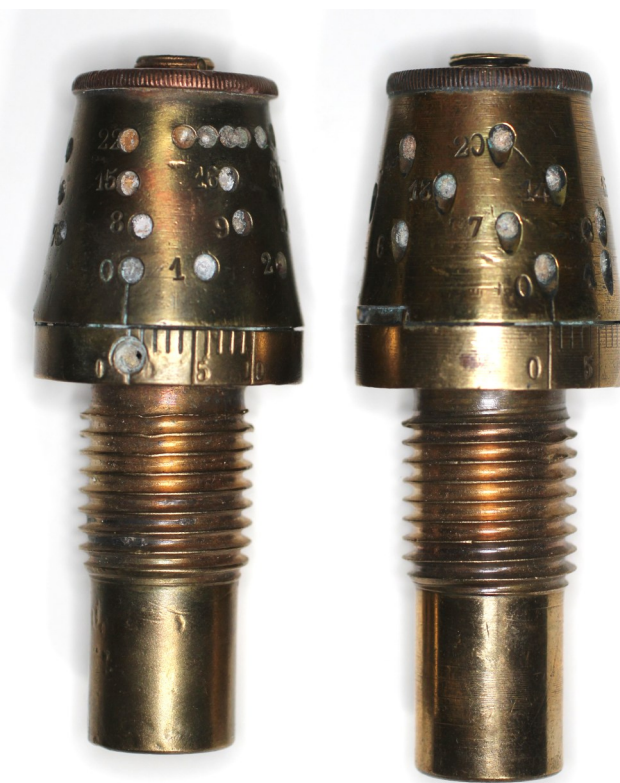
Mise en comparaison du prototype de la fusée de 1879 avec la fusée de 1880 définitive.
