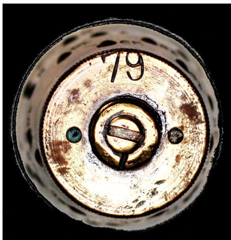
Ecrou de serrage du barillet d'un prototype de 1879 dernier pas avant adoption du modèle définitif.
