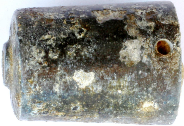
Partie de fausse fusée Mle 1880 en zinc, dont la base portant le filetage a été rompue lors de l'impact. Le trou permettant le visage de la fusée sur le projectile à l'aide de la clé à ergot est bien visible. Pièce de terrain.
