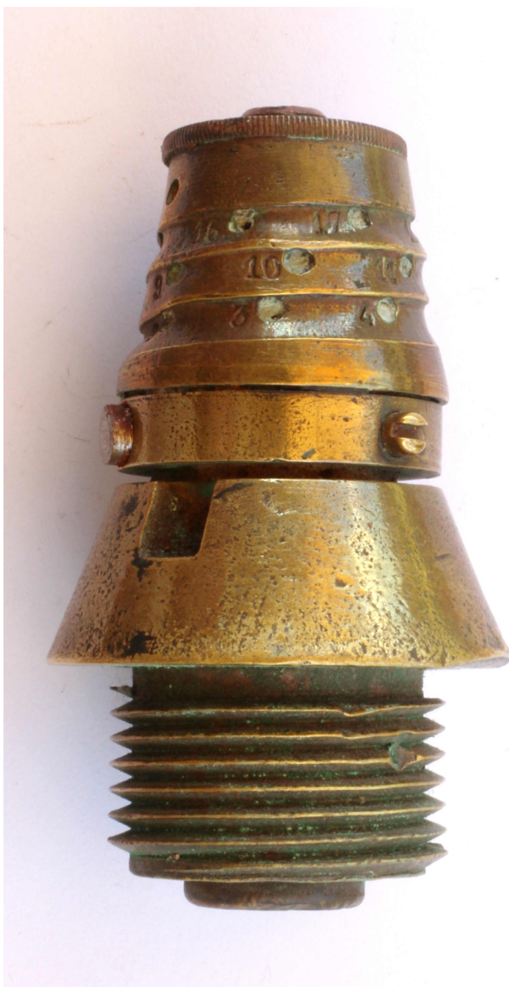
Fusée de campagne de 25 mm à chapeau fixe Mle 1882 modifiée pour l'emploi avec le perce fusée Hirondart. En outre la fusée est vissée sur une bague de raccordement pour montage sur un projectile à oeil de 40/55 Pièce de terrain.
