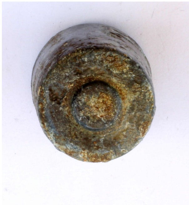
Partie de fausse fusée Mle 1880 en zinc, dont la base portant le filetage a été rompue lors de l'impact. Le trou permettant le visage de la fusée sur le projectile à l'aide de la clé à ergot est bien visible. Pièce de terrain.
