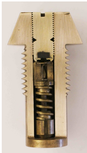
A gauche , fusée Henriet de 1874 à 1 seul canal. - coupe d'époque montrant le mécanisme en position repos. Le modèle qui va en découler va intégrer une chambre à poudre.
