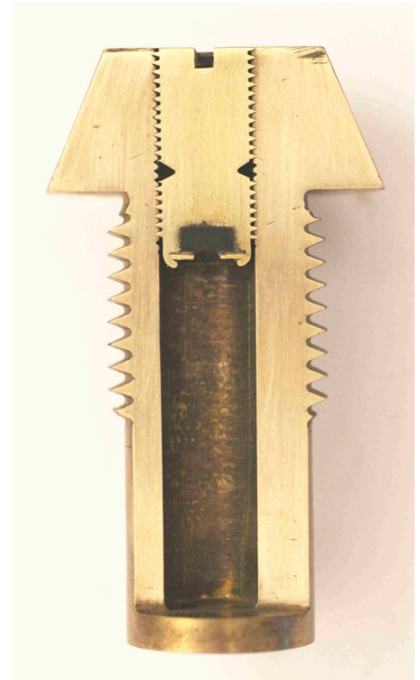
Corps de la fusée Henriet à un seul canal du modèle essayé en 1874 muni de son bouchon percutant — photo Philippe Mention © 2020
