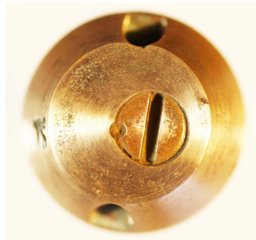
Fusée Henriët à percuteur N° 1 de 1875 modifiée par addition d'une chambre à poudre. - Dessin tiré de Fusées pour projectiles creux 1883 (ECP)
