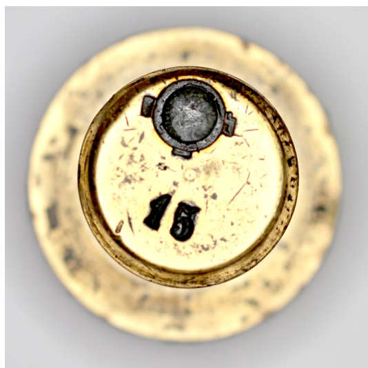
Fusée mixte à cadran et à étage système Henriet 1877—vues en élévation suivant les axes 0 , 10 et 15, vue de tête et côté tampon.—Photos Philippe Mention © 2020-
