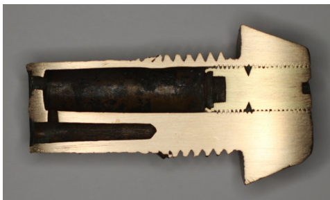
Fusée Henriet du premier type modifiée par adjonction d'une chambre à poudre de 25 mm de long. Spécimens tirés à la Commission d'expériences de Calais en 1975. A gauche spécimen en coupe, Sur le spécimen de droite, on voit le trou qui était avant le tir bouché à la cire et qui a servi à percer le canal de communication entre le canal percutant et la chambre à poudre.— Photos Philippe Mention © 2020
