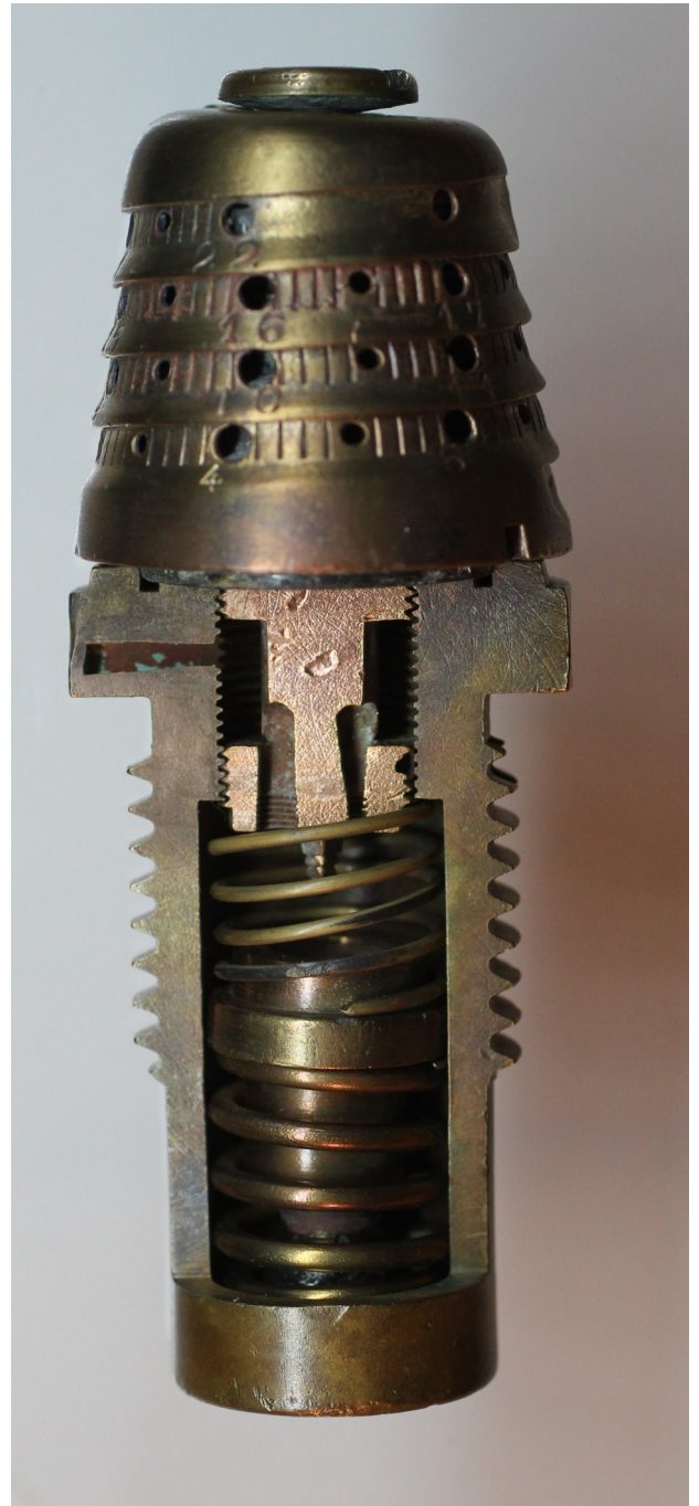
Coupe partielle montrant le dispositif percutant, avec et sans le chapeau couvrant le barillet. - Photo Philippe.Mention© 2026
