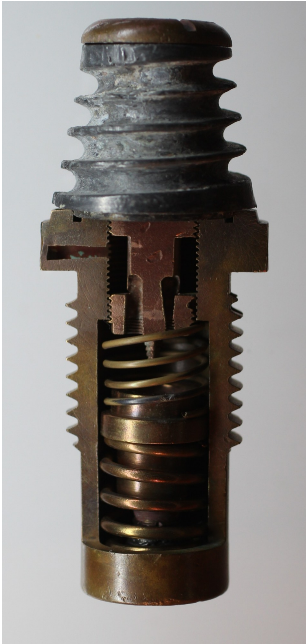
Coupe partielle montrant le dispositif percutant, avec et sans le chapeau couvrant le barillet. - Photo Philippe.Mention© 2026
