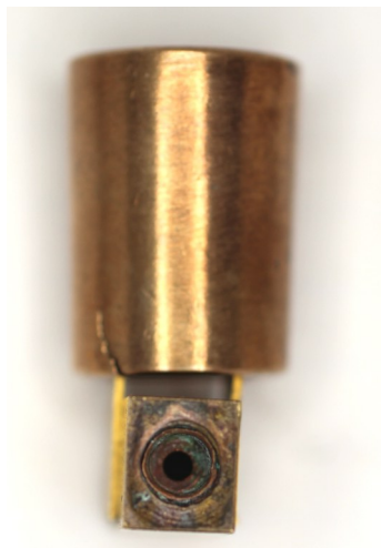
Porte amorce modifié lors de la réfection de 1896 par remplacement de la pastille de fulminate par une capsule de cuivre percée en son centre, et destinée à contenir la nouvelle charge fulminante. Le porte amorce a été pivoté entre les branches du ressort afin de montrer la capsule.
