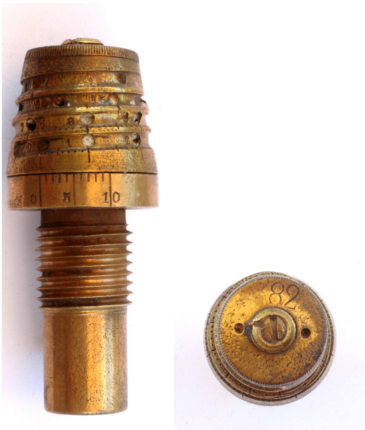
Fusée à chapeau fixe de campagne Mle 1882 destinée en principe à remplacer la fusée de campagne 1880.
