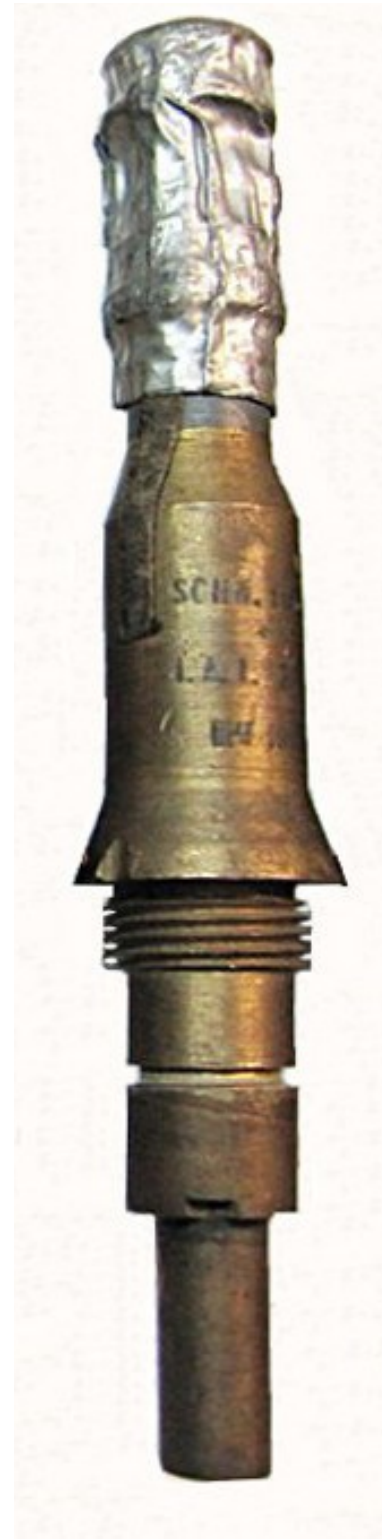
La fusée IAL Mle 1916. A droite spécimen fabriqué par Schneider 'SCHN.': douille porte amorce monobloc; on distingue le trait de peinture bleutée à la limite entre la coiffe et le corps de fusée; on distingue également à gauche sous la coiffe le bout du ruban de fil servant à l'arrachage de la coiffe avant le tir.
