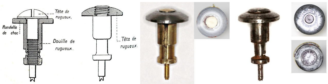
Evolution des rugueux sur fusées IA: De gauche à droite- Le rugueux initial acier/douille d'aluminium. Il est remplacé fin 1915 par un rugueux laiton vissé sur tête acier ; puis à partir de juin 1916 par un rugueux et tête acier vissés; enfin, pour simplifier encore la fabrication, l'extrémité du rugueux est simplement rivée sur la tête
