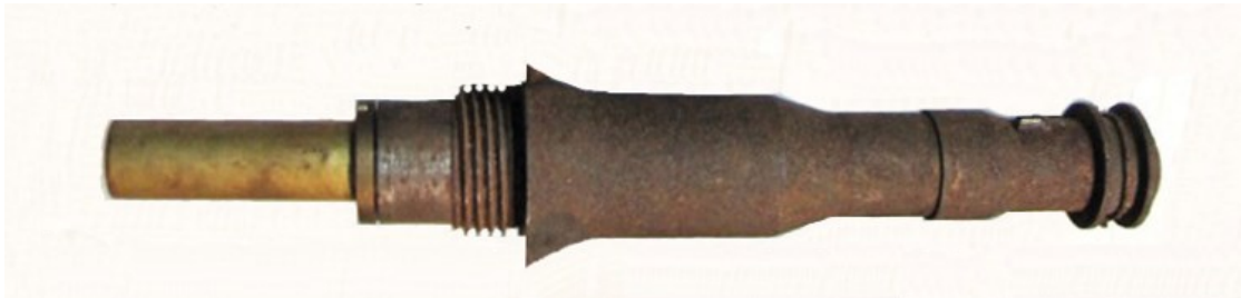
Fusée IA Mle 15 fabriquée durant les derniers mois de 1915 portant la gaine relay du premier type, goupille laiton. Son défaut ! La rouille rapide du corps durant les mauvaises conditions météorologiques de l'hiver.
