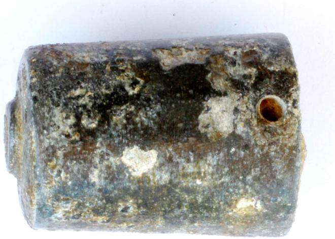
Partie de fausse fusée Mle 1880 en zinc, dont la base portant le filetage a été rompue lors de l'impact. Le trou permettant le vissage de la fusée sur le projectile à l'aide de la clé à ergot est bien visible. Pièce de terrain.
