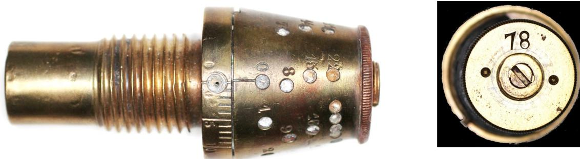
Prototype de fusée à double effet de 1878, combinant le système percutant Budin et le système fusant retenu précédemment. Le barillet porte 22 trous d'évents. Bien daté de 1878. Photo Philippe Mention- @ 2023
