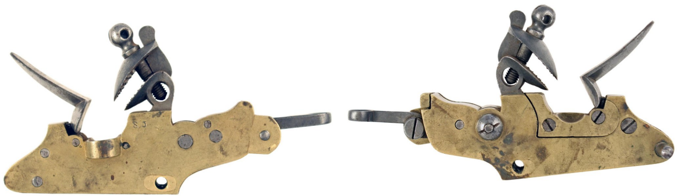
Une autre tentative d'amélioration à la platine anglaise de la fin du XVIIIème, platine plus courte, détente facilement accessible. Nous sommes près de la forme extérieure du coffre définitive. Photo MVV Bonhams.com
