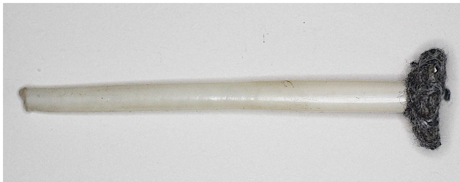
Etoupille préparée munie de son godet de laine, en attente de chargement - Photo Philippe Mention ©2022
