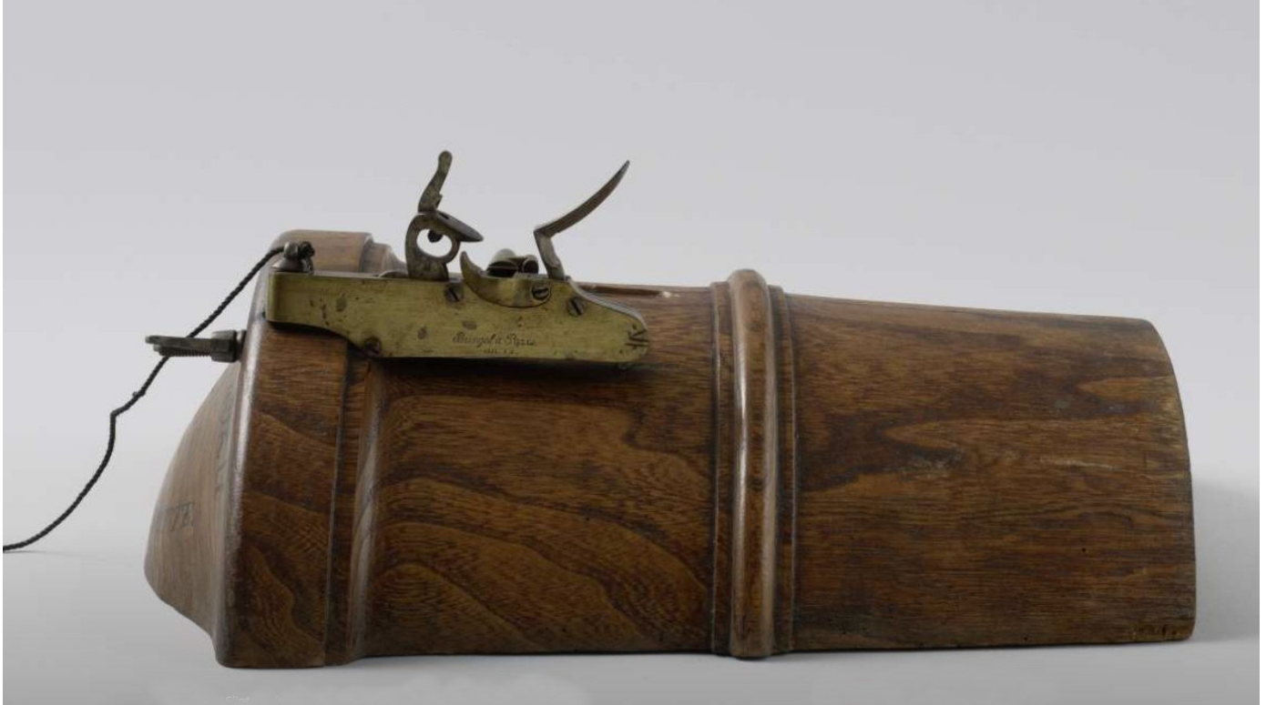
Platine Bringol mise en situation sur un modèle de culasse bois. Celle-ci est fixée parallèlement à l'axe de la pièce, la prolonge filetée de platine traverse le bourrelet arrière de la culasse et la sécurise par un écrou à oreilles tandis qu'un axe solidaire de la partie avant prévient sa rotation. Collection et photo Rijksmuseum—Amsterdam
