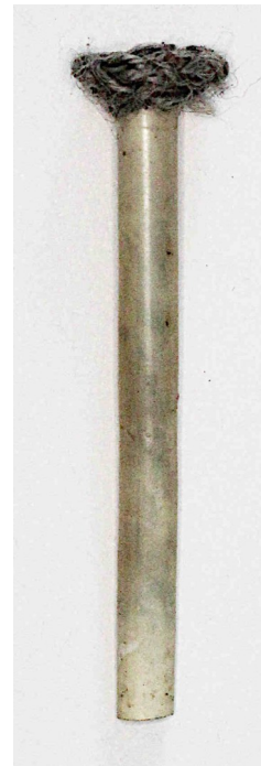
Etoupille ordinaire de la marine britannique avant chargement ; vue longitudinale et de dessus
