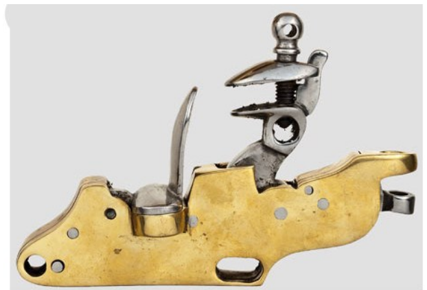
Modèle de platine anglaise définitive généralement rencontrée et en usage jusqu'en 1853. Chien à l'armée
