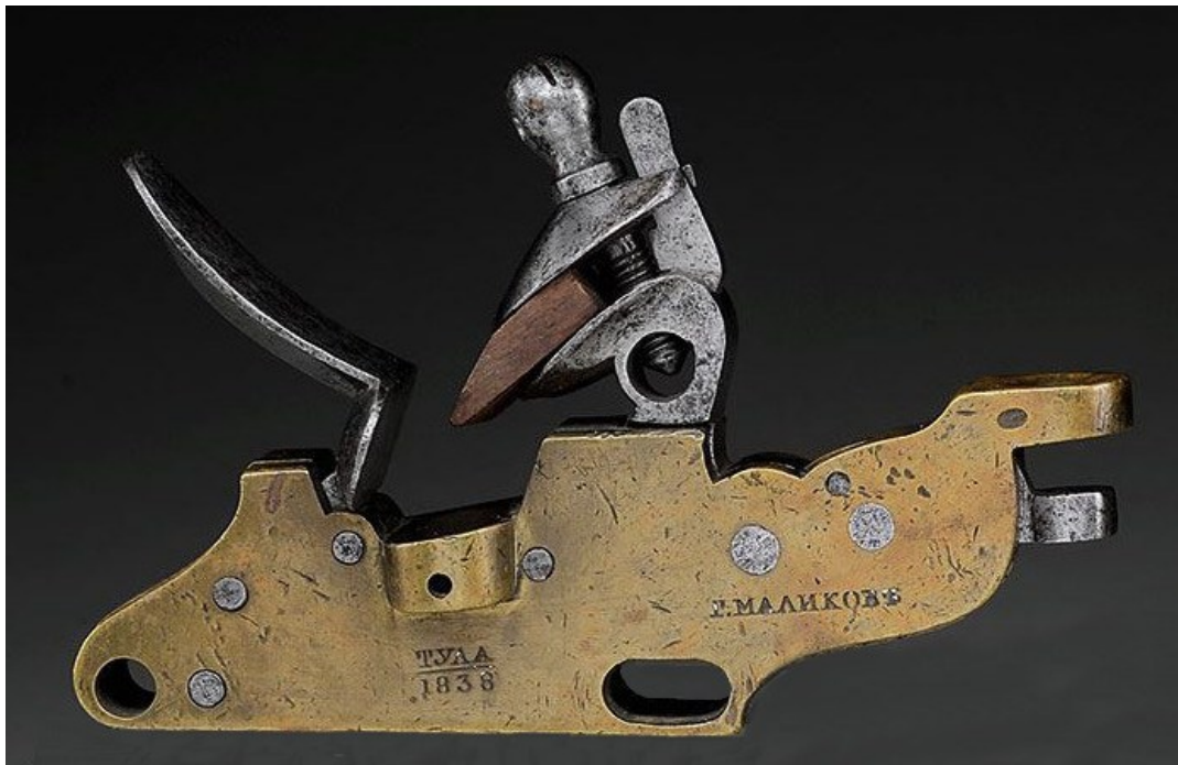
Platine Russe avec marquage de l'arsenal de Tula en 1838. Cette platine est la copie du modèle anglais. S'agit il d'une copie du modèle anglais ou d'une fabrication anglaise pour la Russie qui réceptionna la commande à Tula.
