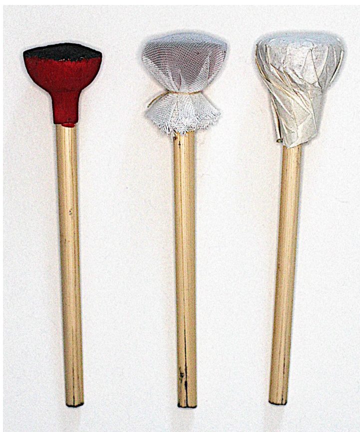
Etoupille de roseau autrichienne chargée, coiffée de sa mousseline et de sa coiffe définitive afin de prévenir le tamisage accidentel du pulvérin.
