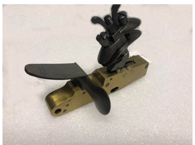
Platines du Royaume du Danemark, la première en haut est signée Ridiger 1827. Les deux modèles possèdent un couvre lumière s'ouvrant du couvercle du bassin inspiré de celui de Tessier de Norbec. Au dessous platine plus tardive post 1820 à chien à double tête
