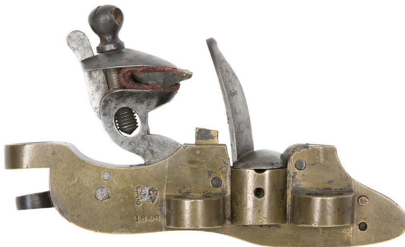
Afin de solutionner la problématique difficulté de fixation de la platine latéralement par rapport à la lumière, le Lt Général Williams Millar imagine sa fixation par deux boulons vissés verticalement sur la culasse. 1820
