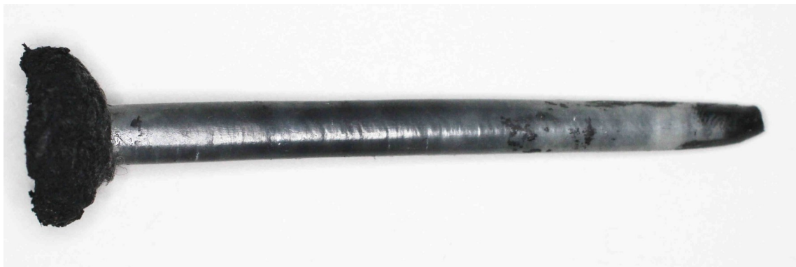
Etoupille chargée et percée, en attente de coiffage - Photo Philippe Mention © 2022-
