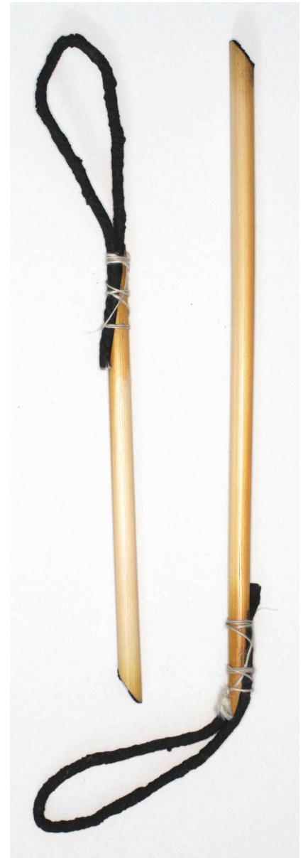
Etoupilles de roseau. A droite pour pièce de siège, longueur 160 mm; à gauche pour pièce de campagne longueur 107 mm Section du roseau environ 5 MM. Photo Philippe Mention © 2022-
