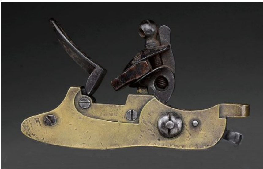
Autre variante de platine anglaise fabriquée avant la standardisation d'un modèle. Sans marquage
