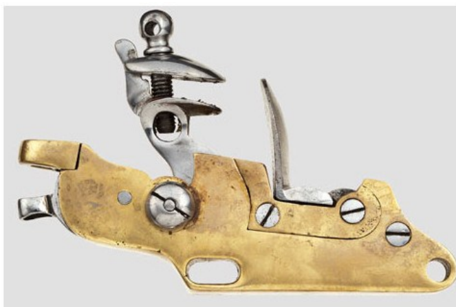
Modèle de platine anglaise définitive généralement rencontrée et en usage jusqu'en 1853. Chien à l'armée
