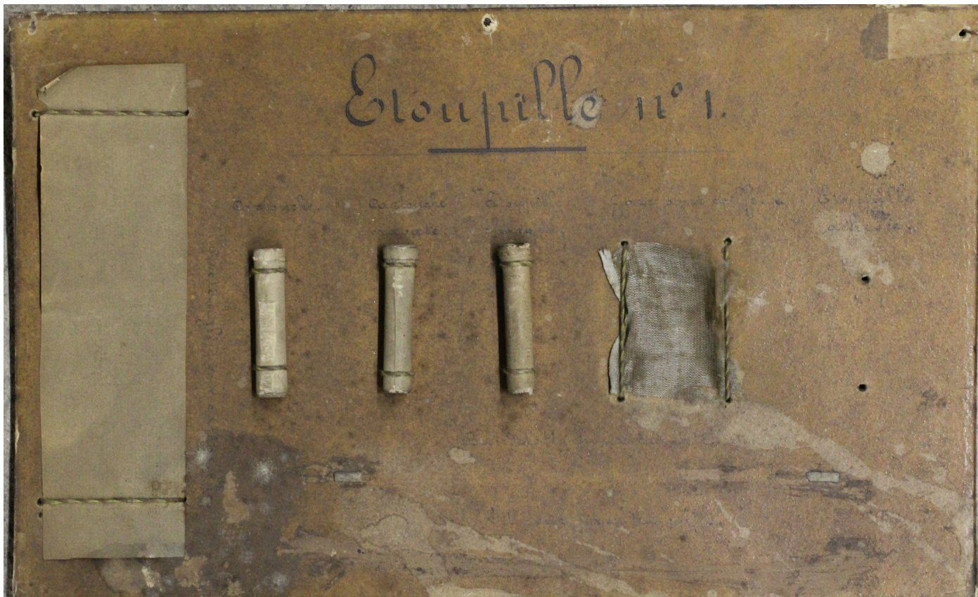
Malgré son mauvais état et le fait qu'il soit incomplet, ce petit tableau appartenant aux collections du Musée Royal de l'Armée de Bruxelles montre les étapes de la fabrication de l'étoupille n°1 réglementaire. De gauche à droite, le rectangle de papier coupé à dimension; le tube roulé; le tube muni de sa cravate; le tube chargé; le carré de gaze. L'étoupille terminée est manquante—Collection MRA Bruxelles—Photo Philippe Mention
