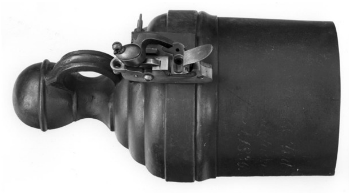
Caronade de la Royal Navy munie de la platine à double effet Davies. Photo et collection RA Woolwich
