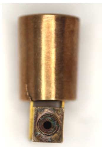
Bc1o: Porte amorce modifié lors de la réfection de 1896 par remplacement de la pastille de fulminate par une capsule de cuivre percée en son centre, et destinée à contenir la nouvelle charge fulminante. Le porte amorce a été pivoté entre les branches du ressort afin de montrer la capsule.
