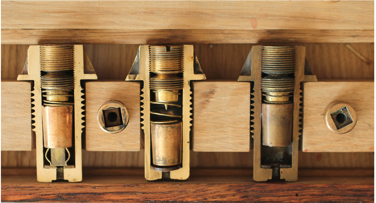
Bc1c2: Trois pièces d'un coffret d'instruction montrant la fusée Budin 1875 aux trois stades:
