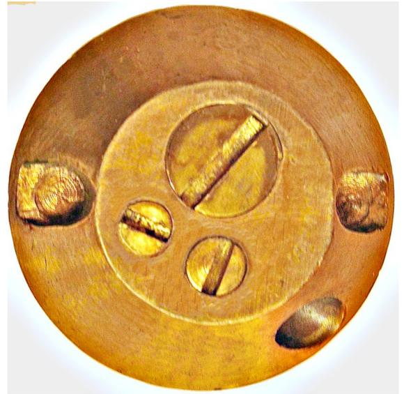
L'appareil concuctant, logé dans un canal pratiqué dans la partie supérieure du corps de fusée et fermé dans le haut par un bouchon fileté. Il se compose d'un rugueux placé la pointe en haut, dans la fond du canal d'un porte amorce munie d'une amorce fulminante et d'une petite charge de poudre, enfin d'un ressort à boudin placé entre le rugueux et le porte amorce. Le porte amorce percé de 3 canaux perpendiculaires 2 à 2, se relie avec le haut du canal fusant, par un bout de mèche à étoupilles.
