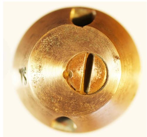
Fusée Henriet à percuteur N° 1 de 1875 modifiée par addition d'une chambre à poudre. - Dessin tiré de Fusées pour projectiles creux 1883 (ECP)
