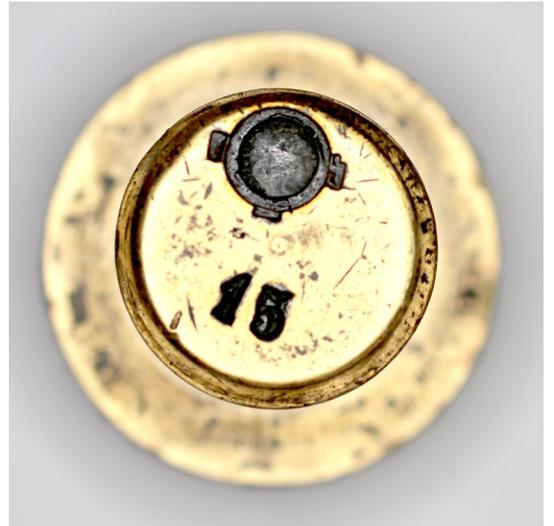
Fusée mixte à cadran et à étage système Henriet 1877—vues en élévation suivant les axes 0 , 10 et 15, vue de tête et côté tampon.—Photos Philippe Mention © 2020-
