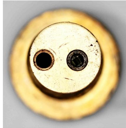
Au dessus, partie antérieure du tampon, on voit les deux événements fermés par une opercule.
