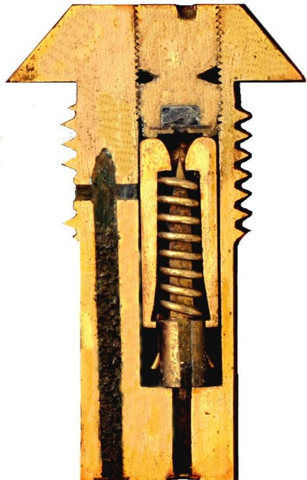
Emploi: Avant de visser cette fusée sur l'obus, dégorgé le canal fusant d'une quantité déterminée par ses tables et variable avec la distance du but et la charge de tir employée. Ce dégorgement s'opère à l'aide d'un forêt en acier monté sur un appareil spécial.
