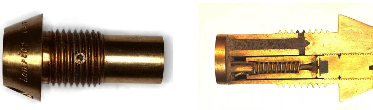
*Fusée Henriet N°2 en coupe d'époque à droite , mécanisme au repos. spécimen de coffret à gauche.. On voit sur ce spécimen l'emplacement du trou de perçage établissant la communication entre canal percutant et chambre à poudre allongée.— Photos Philippe Mention© 2020*
